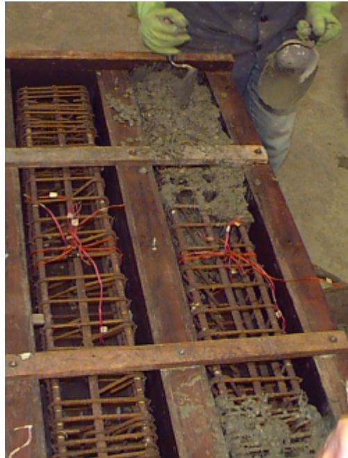
FIGURA 3.12 - Moldagem do Pilar Piloto 1
