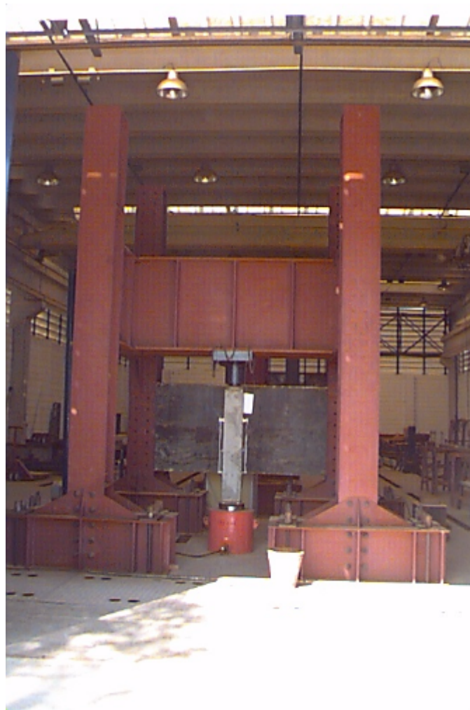
FIGURA 3.7 – Pórtico de Reação Instalado no Galpão de Ensaios do Laboratório
