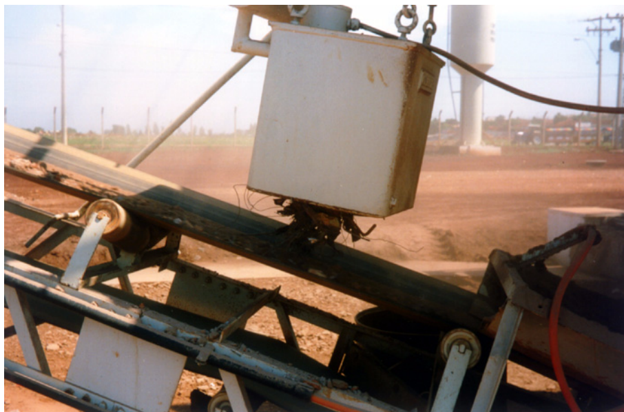
Figura 3.3 - Eletroímã para retirada de metais ferrosos
