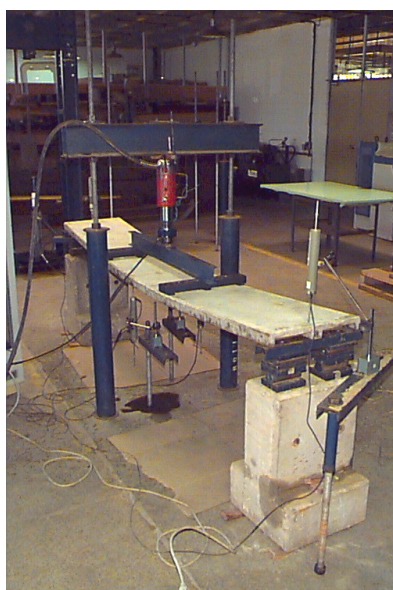
Figura 6.7 - Aparelhagem para aplicação de força
