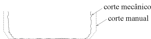
Fig. 5.2: Superfícies de corte realizadas mecânica e manualmente
