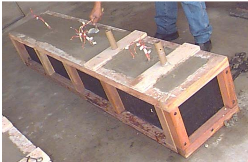
(b) - Viga depois de moldada.
