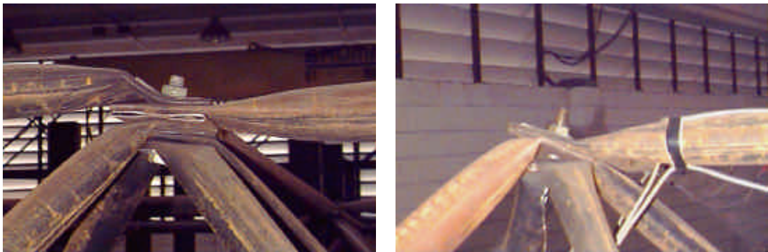
Figura 5.10 Configuração dos nós da estrutura após a ruína.
