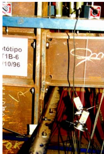
Figura 8.149 – Configuração deformada da chapa de topo (CT1B-6)
