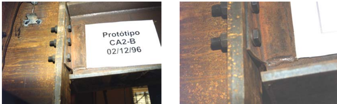
Figura 8.25 – Deformações nas cantoneiras após o ensaio
