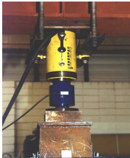
Figura 7.8 - Atuador hidráulico e célula de carga
