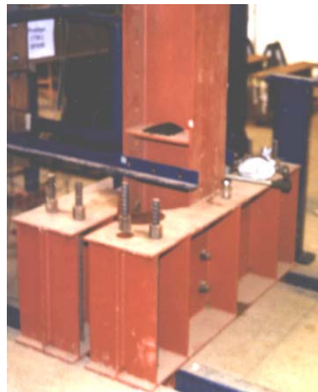
Figura 7.2 - Aparelho de apoio dos pilares do pórtico de reação
