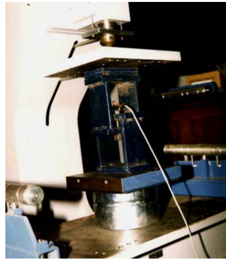
Figura 4.20 – Detalhe do ensaio de calibração dos parafusos
