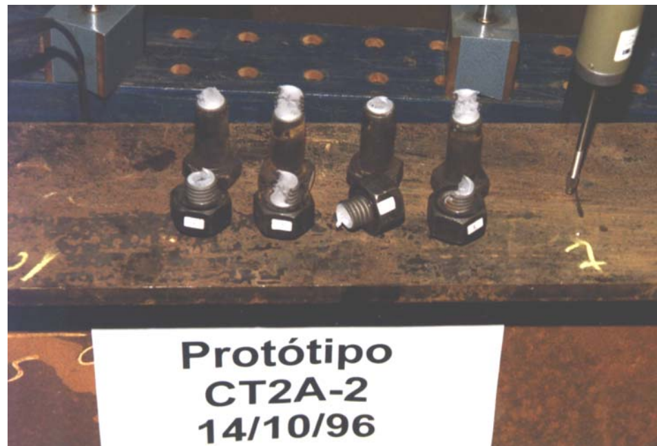
Figura 7.25 - Aspecto da ruptura dos parafusos (protótipo CT2A-2)
