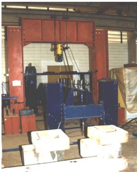
Figura 7.1 - Pórtico de reação
