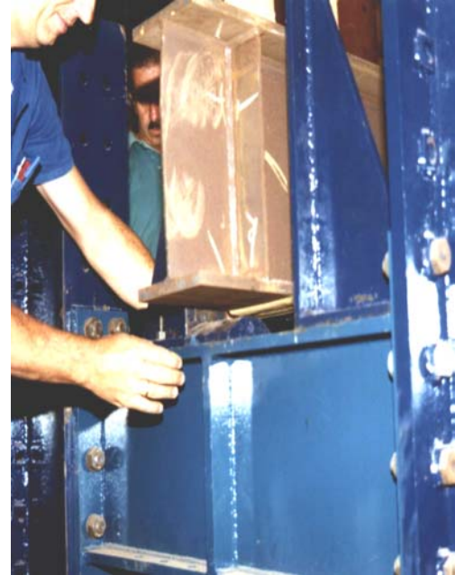
Figura 7.6 - Detalhe do apoio dos protótipos
