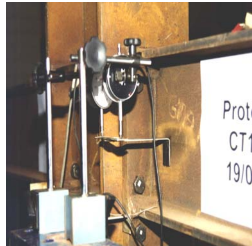
Figura 7.10 - Dispositivo para medição da rotação da viga
