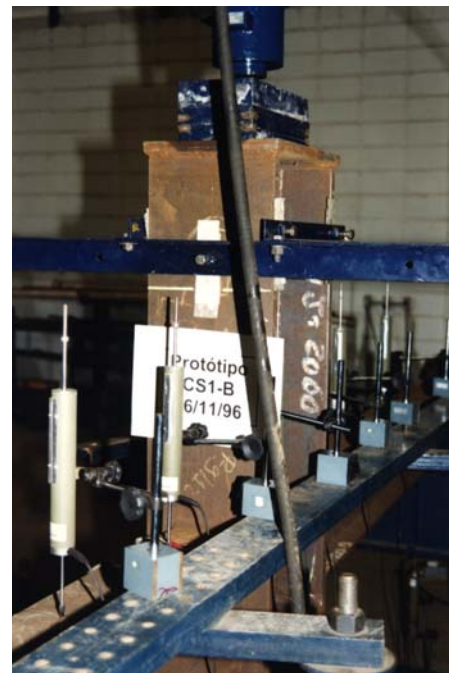
Figura 7.21 - Posicionamento dos transdutores sobre a mesa superior dos protótipos
