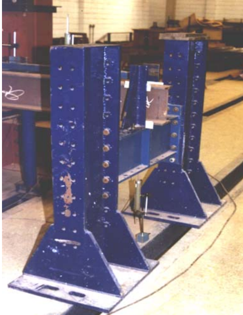
Figura 7.5 - Pórtico de apoio dos protótipos
