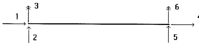
FIGURA 3.4 - Coordenadas locais de um segmento de viga
