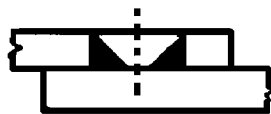
FIGURA 4-12 Exemplo de solda de filete em furo ou rasgo. Adaptada do EUROCODE 3 [ 24 ].
