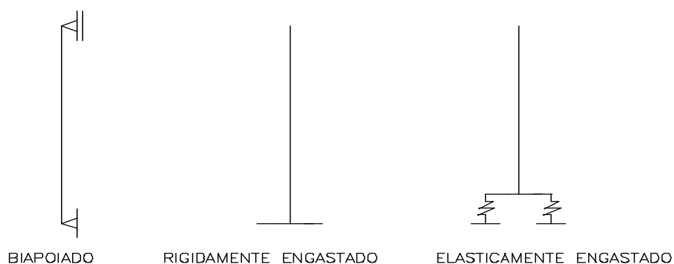
FIGURA 7.3 - Vinculação admitidas para os pilares.
