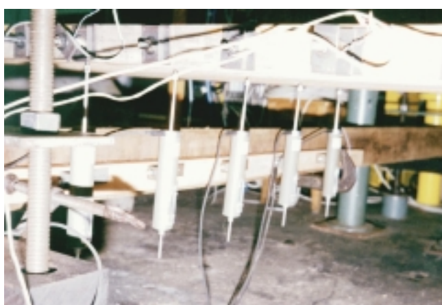
FIGURA 80 - Foto dos Transdutores de deslocamentos no Modelo Reduzido
