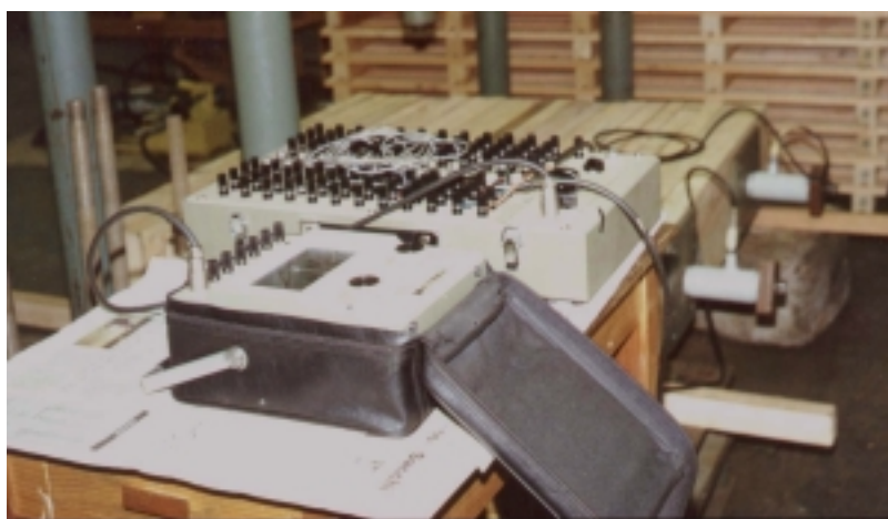
FIGURA 46 - Sistema de Leitura das Cargas nas barras de protensão
