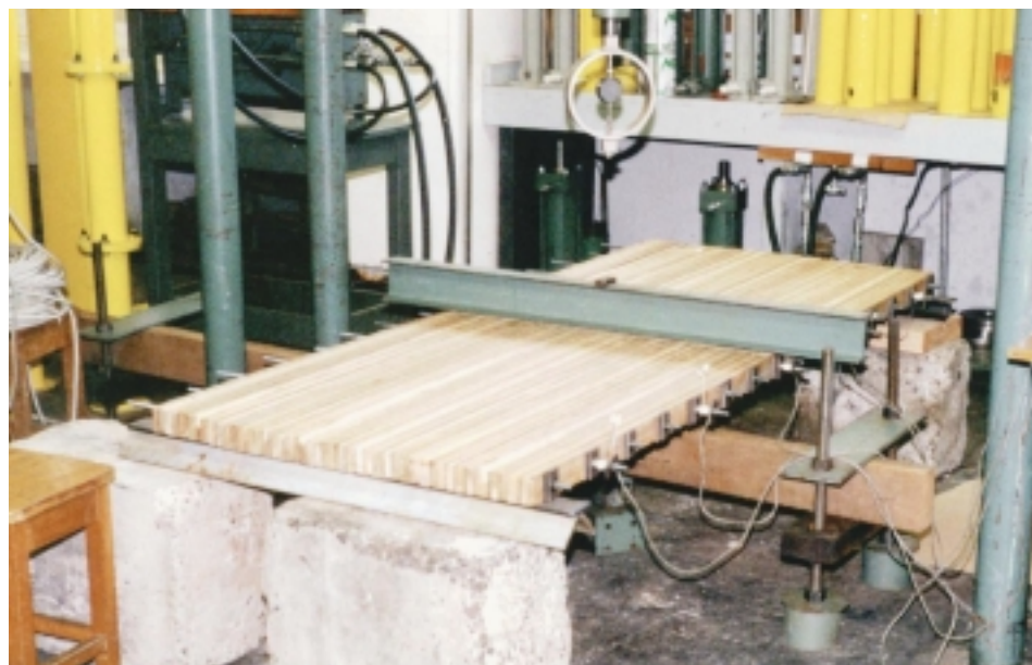
FIGURA 79 - Foto do Modelo Reduzido Ensaio de Flexão: Efeitos de Juntas
