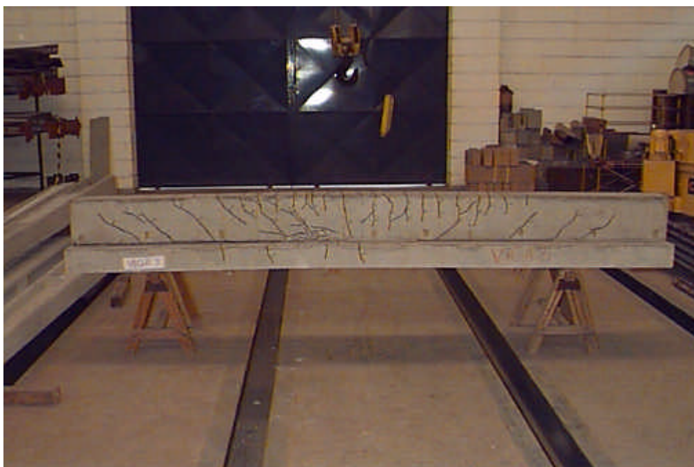
Figura 5.12(d) - Forma de ruptura da viga 3.
