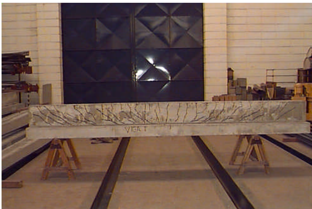
Figura 5.12(a) - Forma de ruptura da viga 1.
