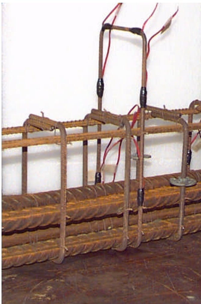
Figura 5.11(a) - Detalhe da instrumentação da armadura de costura da interface com extensômetros elétricos de resistência.
