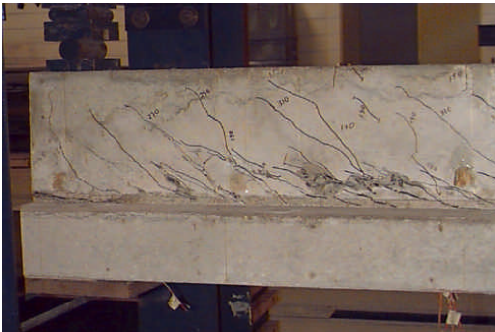
Figura 5.12(c) - Detalhe da biela de compressão, junto ao apoio, formada na ruptura da viga 2.
