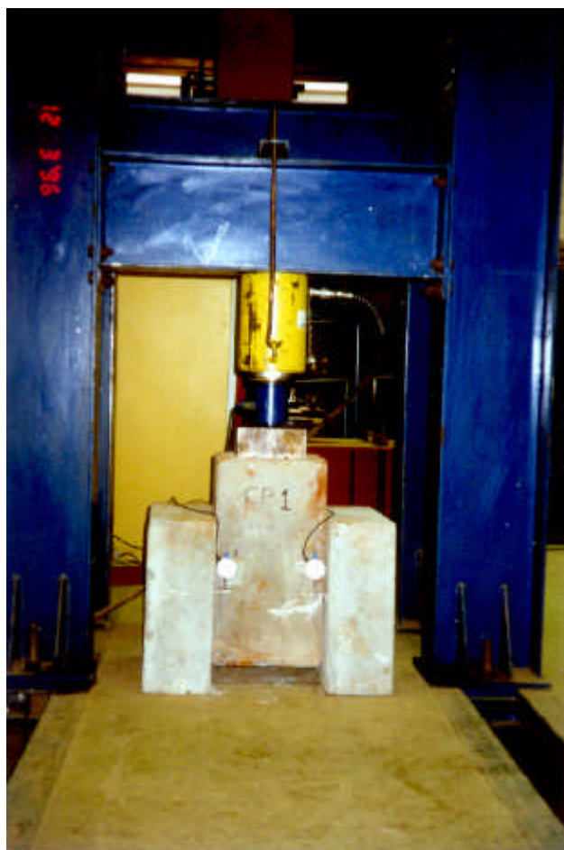
Figura 4.7(c) - Estrutura de reação e corpo-de-prova posicionado para ensaio
