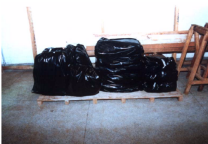
Figura 4.1 - Fotografia do armazenamento do cimento e sílica ativa
