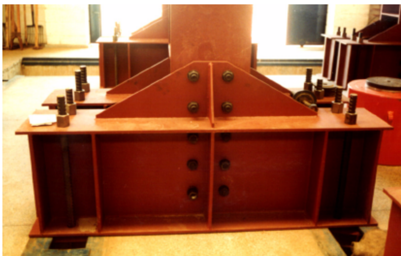
Figura 4.18 - Detalhe da fixação do pórtico na laje de reação
