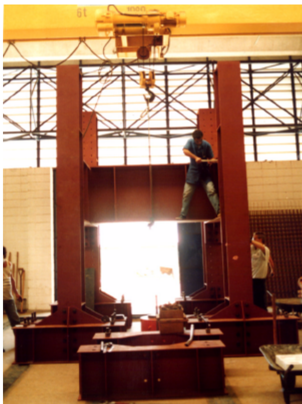
Figura 4.17 - Fixação da grelha nas colunas numa altura determinada para ensaios das séries 1 a 4
