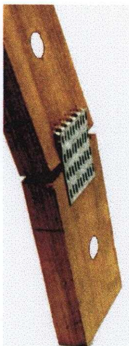
FIGURA 26 - Ruptura por arrancamento paralelo da chapa
