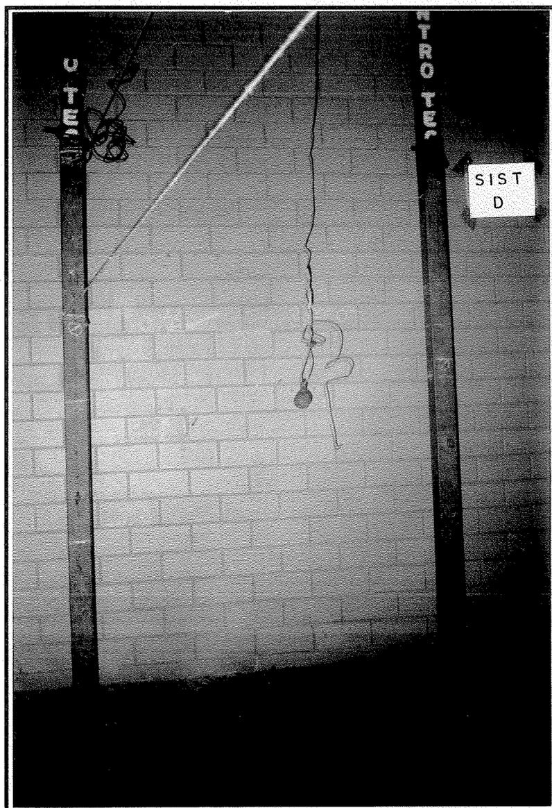
Figura 22 - Sistema construtivo D. Vista do ensaio com esfera de 1,0kg.
