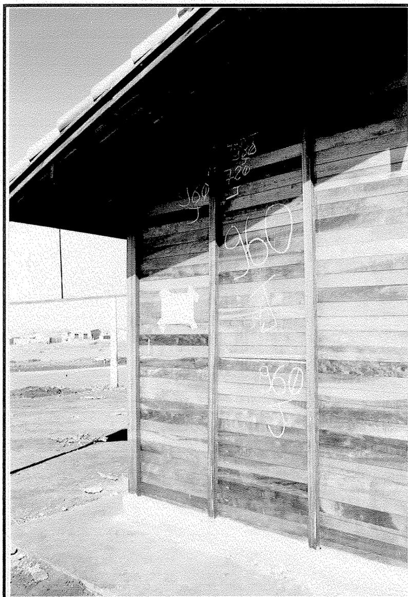
Figura 18 - Sistema construtivo H. Configuração do estado de ruína da parede. Lado externo. Impacto com energia de 960J.
