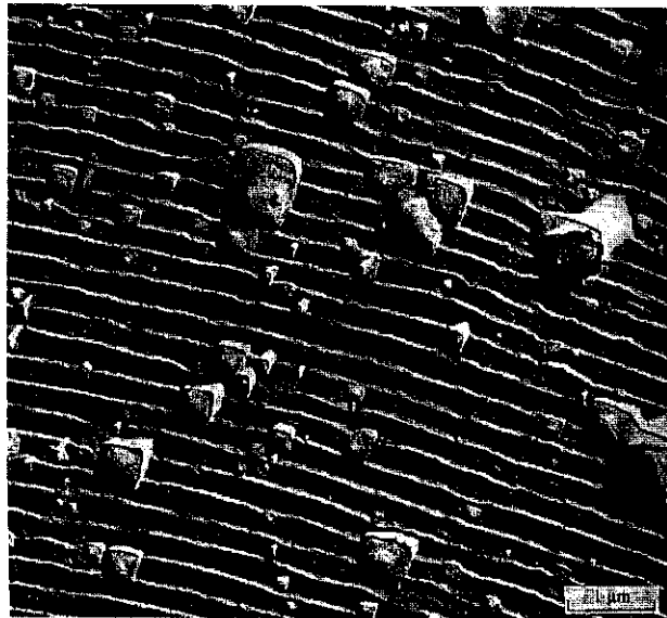
Figura 3.4 - Ondulações por fadiga na superfície de ruptura de uma liga de alumínio 2024-T3.
