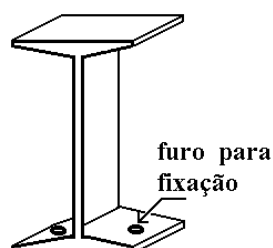
Figura 2.19 - Segmentos de perfis metálicos "I"
