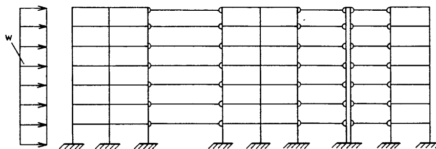
FIGURA 3.1 - Modelo de associação plana de painéis
