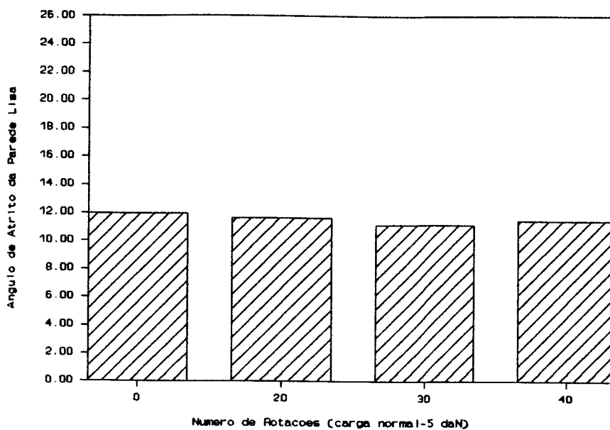
FIGURA 93. Valores médios do ângulo de atrito da parede, obtidos dos testes de cisalhamento de atrito com a parede (lisa) instantâneo (farinha de trigo).
