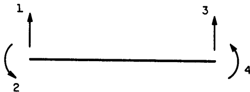
Fig. 2.5 - Coordenadas locais de um trecho de viga
