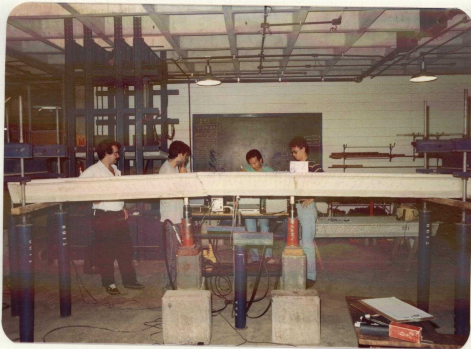
FOTOGRAFIA 33 - MODELO 2/2 APÓS RUPTURA POR FLEXÃO
