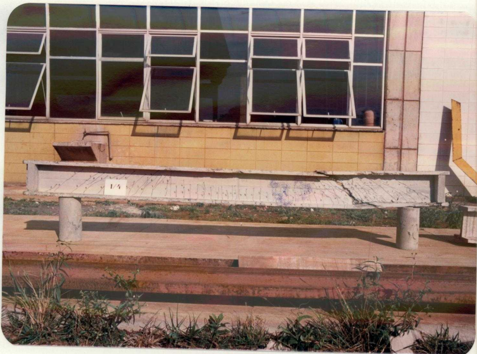
FOTOGRAFIA 29 - CONFIGURAÇÃO DE RUÍNA DA ALMA DO MODELO 1/4
