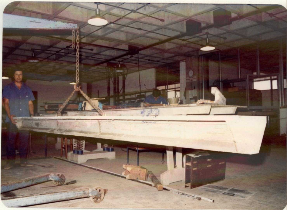
FOTOGRAFIA 19 - TRANSPORTE DO MODELO 2/1 PARA O PÓRTICO DE ENSAIO
