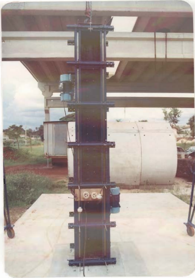
FOTOGRAFIA 1 — FÔRMA PARA MOLDAGEM DOS MO- DELOS DA SÉRIE 1
