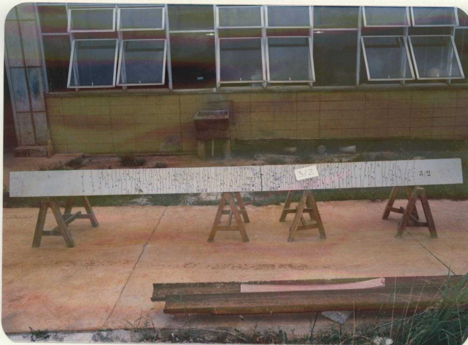
FOTOGRAFIA 37 - CONFIGURAÇÃO DE RUÍNA DA MESA TRACIONADA DO MODELO 3/2
