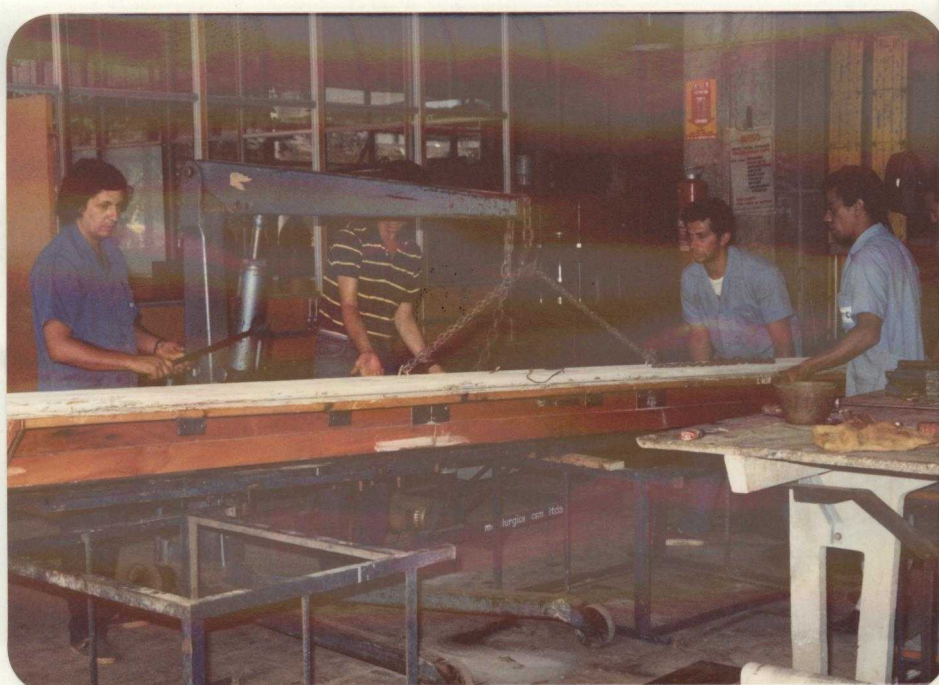
FOTOGRAFIA 16 - DESMOLDAGEM DO MODELO 2/1
