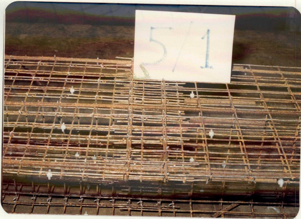
FOTOGRAFIA 43 - DETALHE DA REGIÃO DE EMENDA DAS ARMADURAS DO MODELO 5/1
