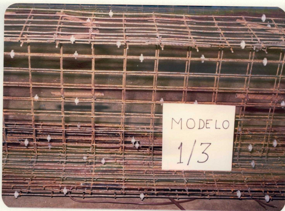
FOTOGRAFIA 03 - DETALHE DA ARMAÇÃO DO MODELO 1/3
