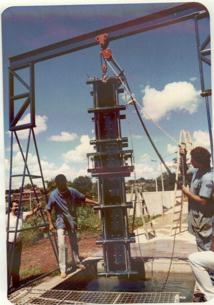
FOTOGRAFIA 07 - COLOCAÇÃO DA FÔRMA NO TANQUE DE CURA APÓS A MOLDAGEM DE UM DOS MODELOS DA SÉRIE 1
