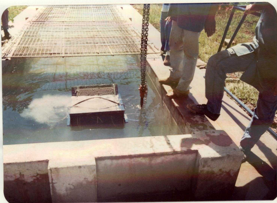
FOTOGRAFIA 08 - INÍCIO DO PROCESSO DE CURA DE UM DOS MODELOS DA SÉRIE 1
