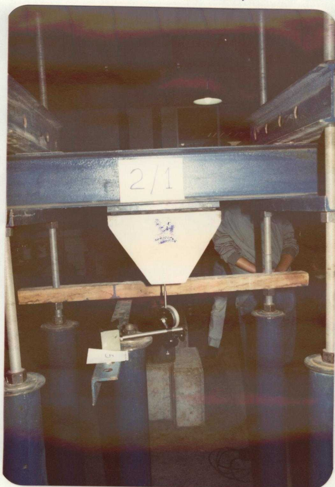
FOTOGRAFIA 21 - DETALHE DO SISTEMA DE APLICAÇÃO DE FORÇAS NO ENSAIO DO MODELO 2/1
