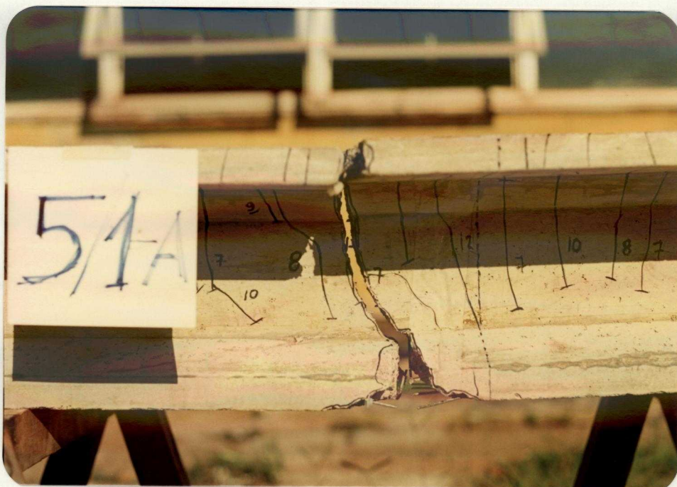
FOTOGRAFIA 46 - DETALHE DA SEÇÃO DE RUPTURA DO MODELO 5/1A
