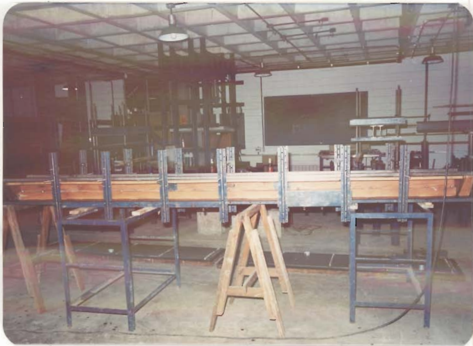
FOTOGRAFIA 3 — FÔRMA PARA MOLDAGEM DOS MODELOS DA SÉRIE 2 E SEQUINTE
