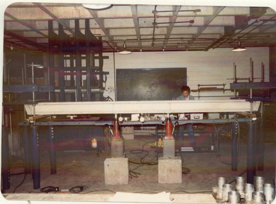
FOTOGRAFIA 20 - MODELO 2/1 POSICIONADO NO PÓRTICO PARA ENSAIO
