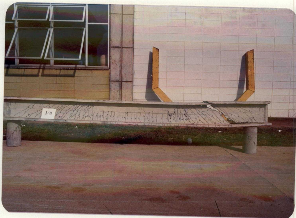
FOTOGRAFIA 25 - CONFIGURAÇÃO DE RUÍNA DO MODELO 1/3
