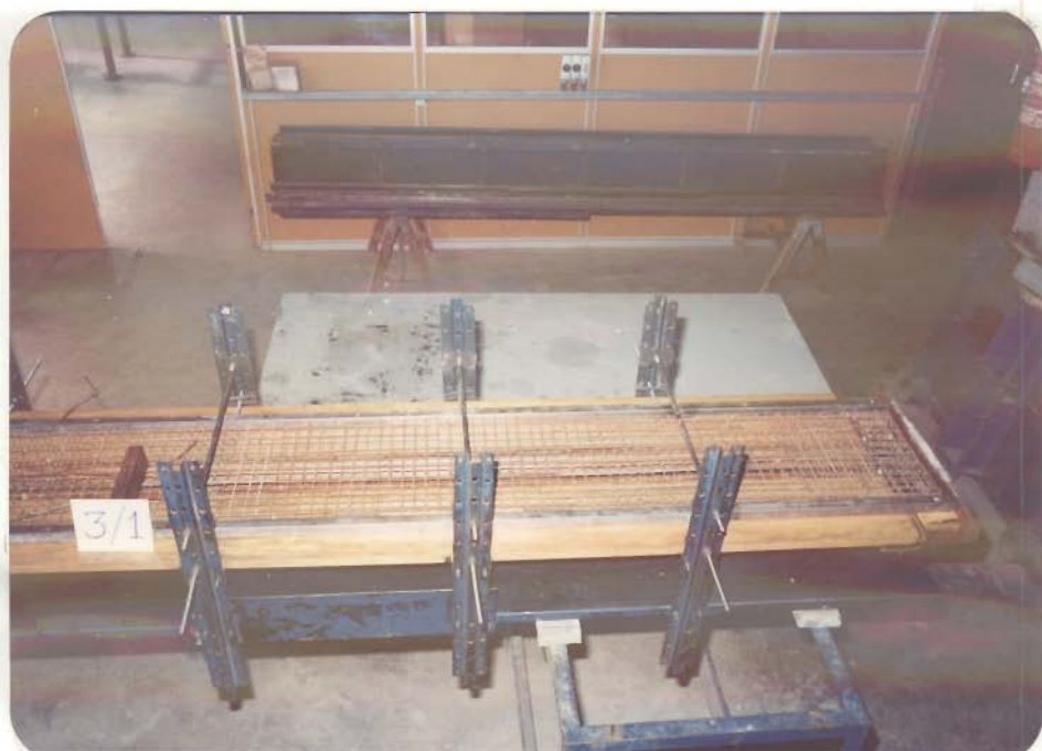
FOTOGRAFIA 8 - DETALHE DA ARMAÇÃO DO MODELO 3/1
