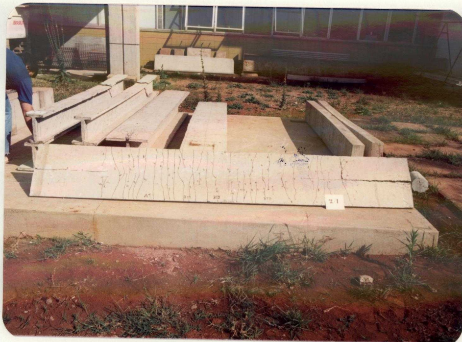
FOTOGRAFIA 27 - CONFIGURAÇÃO DE RUÍNA DA MESA TRACIONADA DO MODELO 1/2
