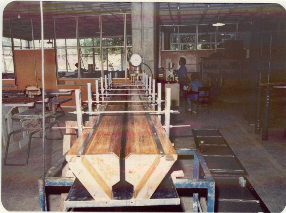
FOTOGRAFIA 11 - FÔRMA UTILIZADA PARA MOLDAGENS DOS MODELOS DAS SÉRIES 2,3,4 E 5.
