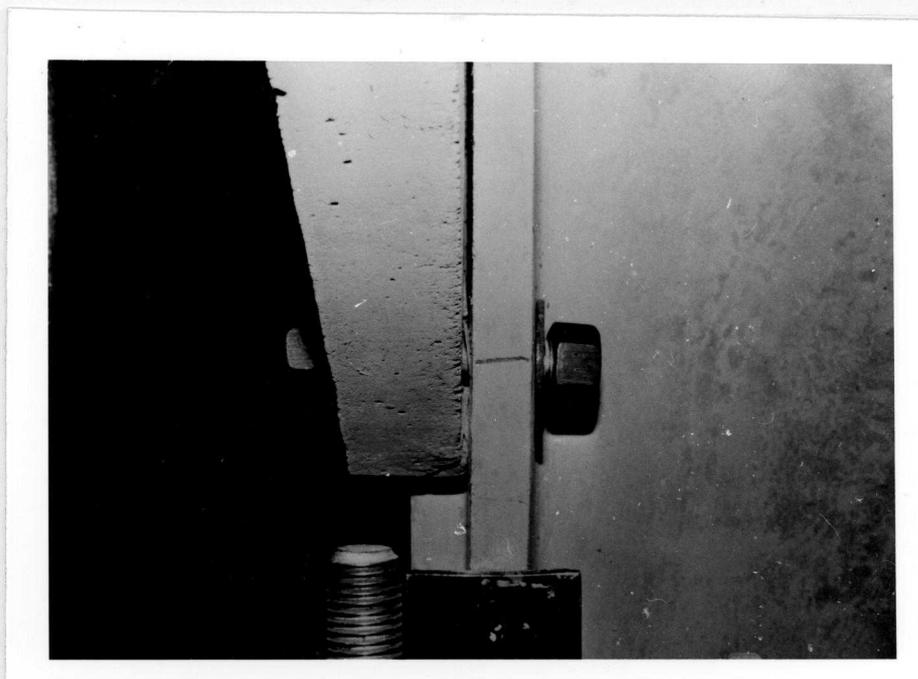
FOTO 5 - Aspecto do cisalhamento da articulação sapata/tirante correspondente à ruptura do modelo. Observa-se o corte ocorrido na região dos fios da rosca.
