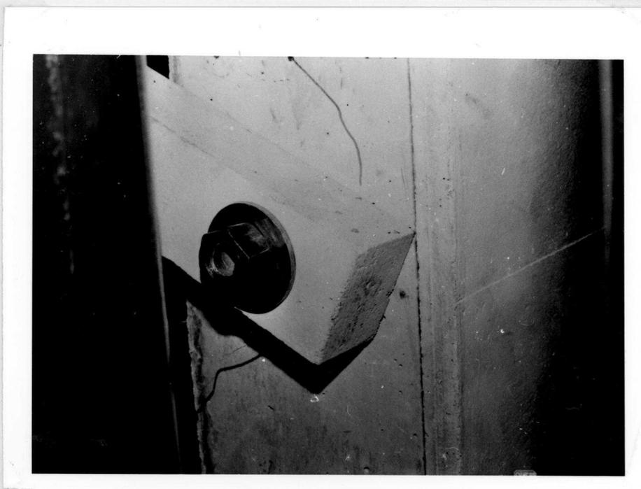
FOTO 7 - Vista da articulação sapata/tirante simétrica à das fotos 5 e 6 e que não apresentou ruptura. Observa-se menor fissuração de cisalhamento da sapata em relação à foto 6 devido à variação das dimensões da nervura.
