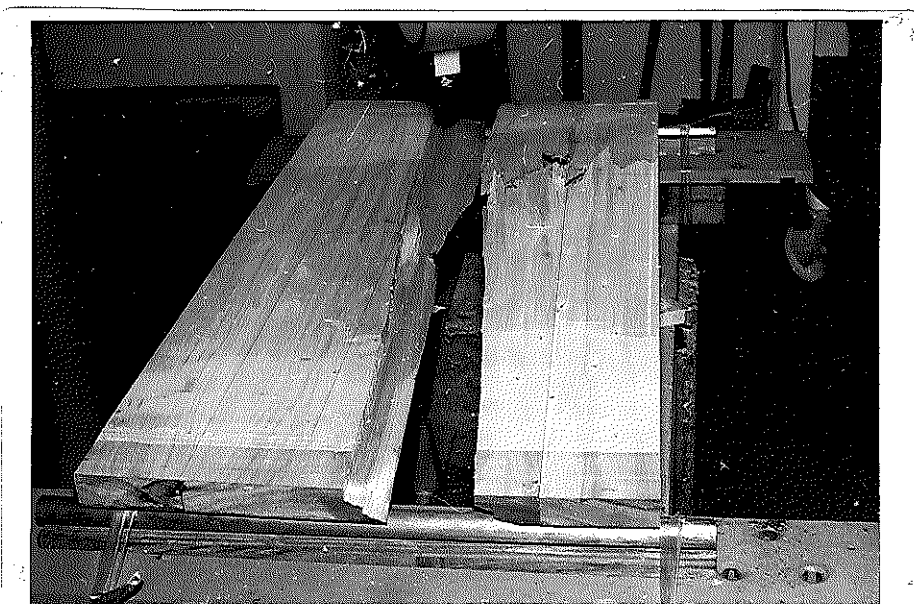
Fig. 41- Ruptura do modelo por flexão na fibra tracionada
