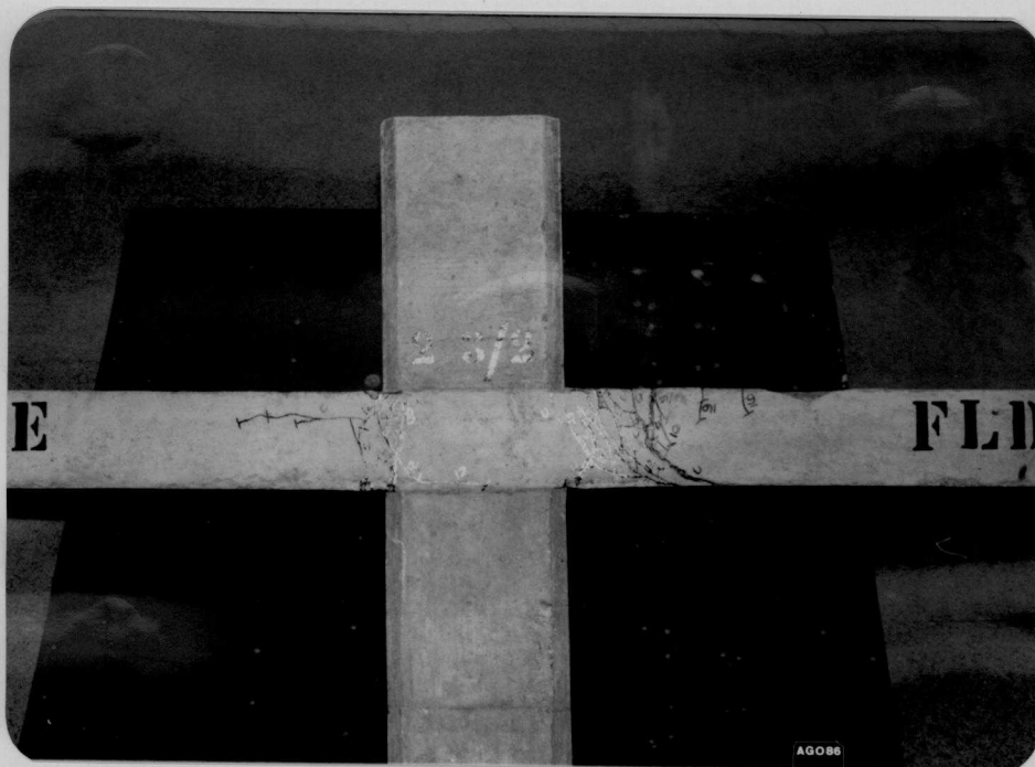
Fig. 3.1.6.b - Fissuração na face lateral do modelo EdL 23/2.
