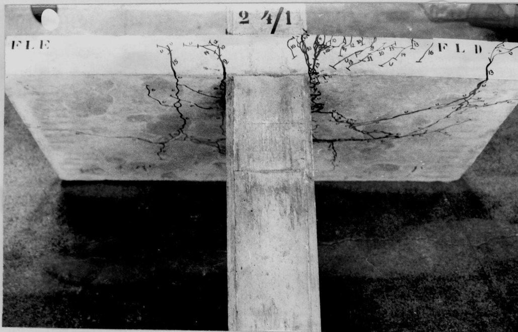
Fig. 3.1.8.b - Fissuração na face lateral do modelo EdL 24/1.
