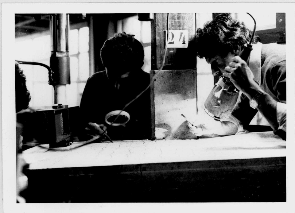
Fig. 6.14 - Acompanhamento de fissuração do modelo 24.
