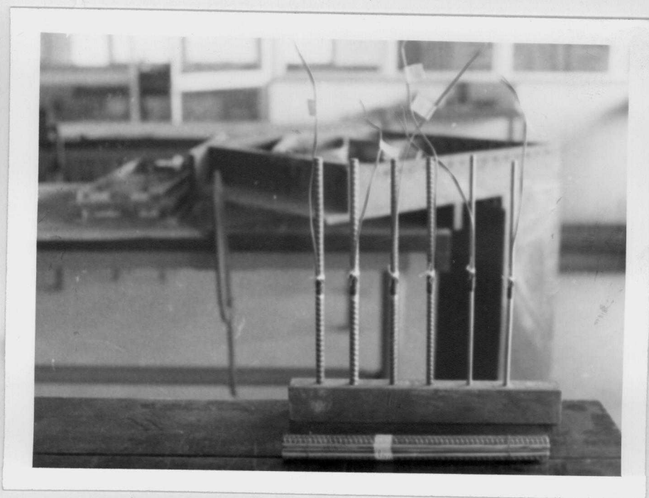
Fig. 6.2 - Corpos de prova para ensaio à tração das armaduras dos modelos.
