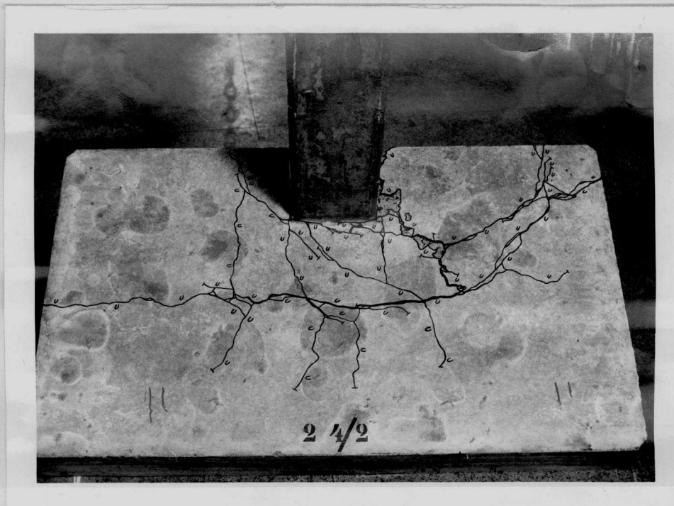
Fig. 3.1.9.c - Fissuração na face inferior do modelo EdL 24/2.
