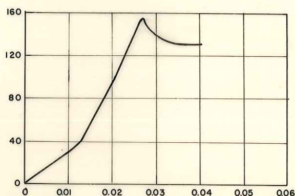
FIG. 2.17-CURVA TÍPICA CARGA-DEFORMAÇÃO NO ARRANCAMENTO DE PREGOS.
