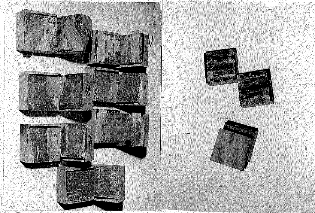
Fig. 183 - Ruptura dos corpos de prova de cisalhamento na compressão
