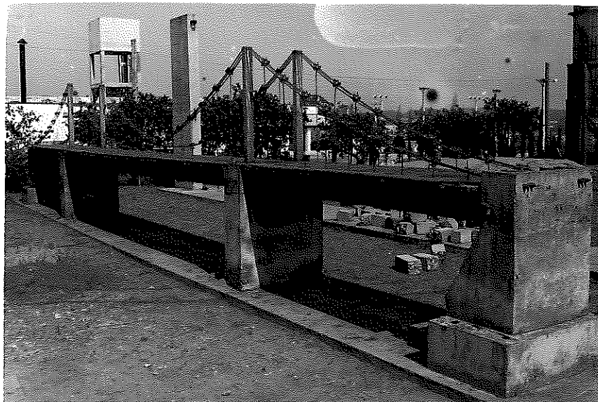
Figura 23 - Ponte pênsil, com vigas principais em madeira laminada, modelo reduzido-ensaio (23).
