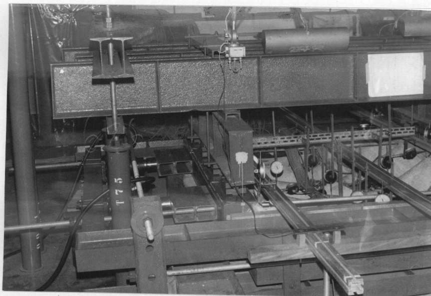
Foto 6.25 - Vista do dispositivo de reação e do de aplicação de carga horizontal.
