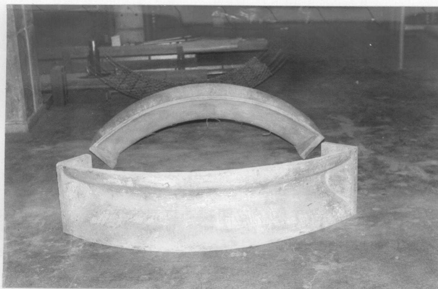
Foto 6.32 - Aspecto das peças após a desforma.
