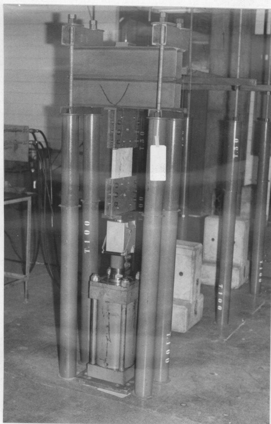
Fig. 6.53 - Ensaio provisório de compressão para testar o dispositivo de fixação.
