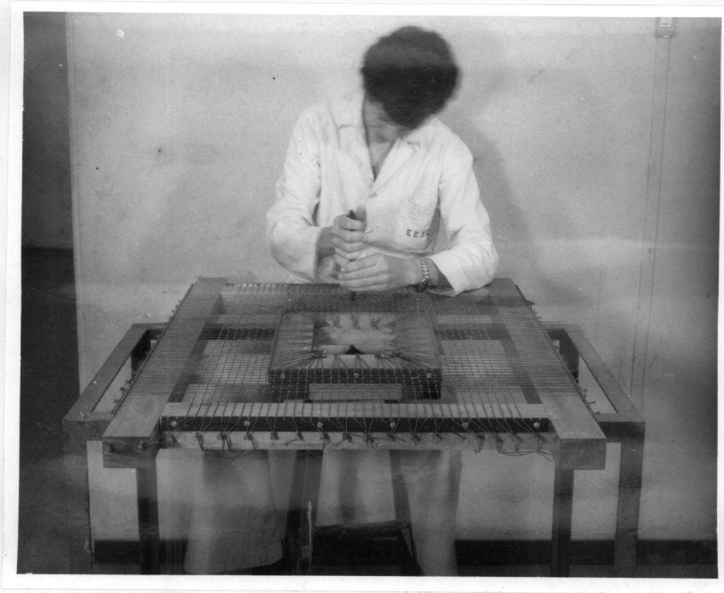
FIGURA AII.7 — TRABALHO DE AMARRAÇÃO DOS FIOS
