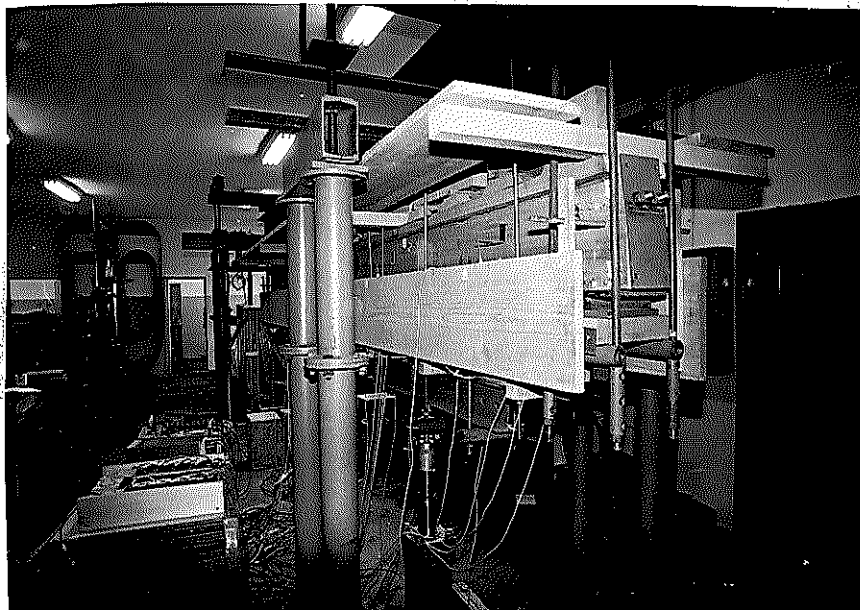
FIG. 7.32 - PERSPECTIVA DA TÁBUA DE FIXAÇÃO DOS TRANSDUTORES INDUTIVOS
