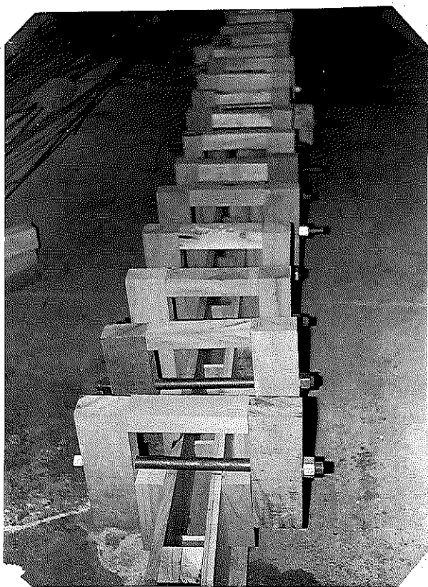
FIG. 7.14 - ESQUEMA DE MONTAGEM - COLAGEM DAS MEMBRANAS INFERIORES
