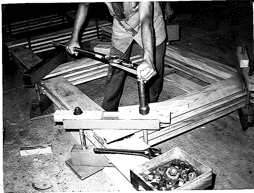
Fig. 6.7 - Adesivo de Pressão Utilizando-se Torquímetro
