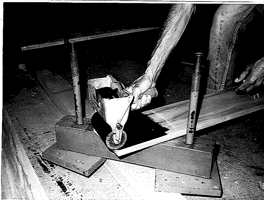
Fig. 6.5 - Aplicação do Adesivo
