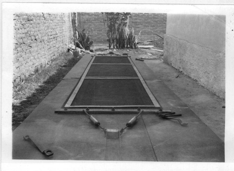
Fig. 3.4.4 - Forma para fabricar as placas tipo 1, vendo-se as telas mantidas esticadas através de esticadores.
