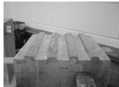
(a) Faixas de madeira coladas no fundo da forma para execução das ranhuras na superfície do segmento de concreto. (b) Superfície do segmento após a concretagem.
