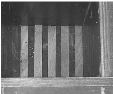
(a) Faixas de madeira coladas no fundo da forma para execução das ranhuras na superfície do segmento de concreto. (b) Superfície do segmento após a concretagem.
