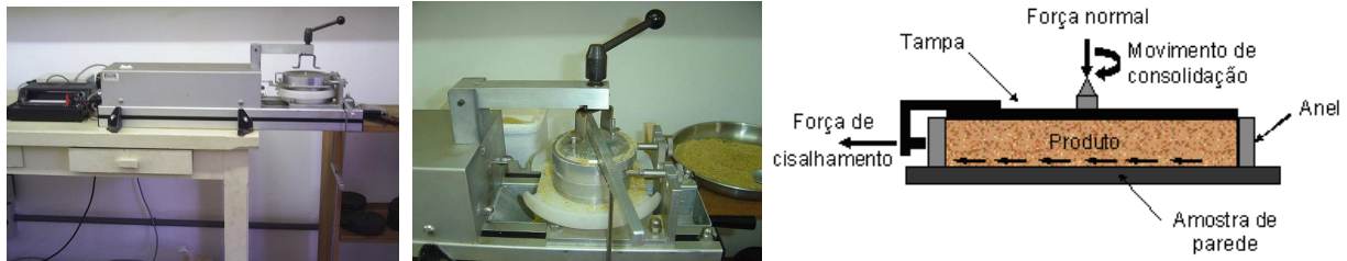
Figura 1 – Aparelho de cisalhamento direto, Jenike Shear Tester.
