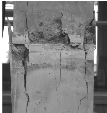
Figura 15 – Configuração de ruína do modelo de alta resistência M5.
