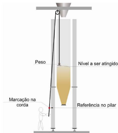
Figura 9 – Controle do nível de produto no silo piloto (CHEUNG, 2007).
