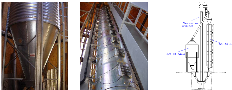
Figura 5 – Silo para armazenagem, silo piloto e a estação experimental, respectivamente.
