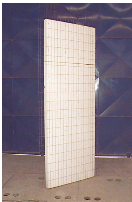
Figura 3 – Pré-painel (núcleo de EPS + tela soldada)
