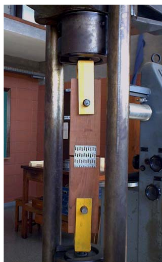
Figuras 7 – Ensaio de Tração da Ligação
