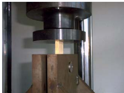
Figuras 5 e 6 – Ensaio de Compressão paralela e de Embutimento em corpos-de-prova padronizados
