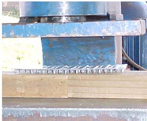
Figura 3 – Esquema de prensagem do CDE
