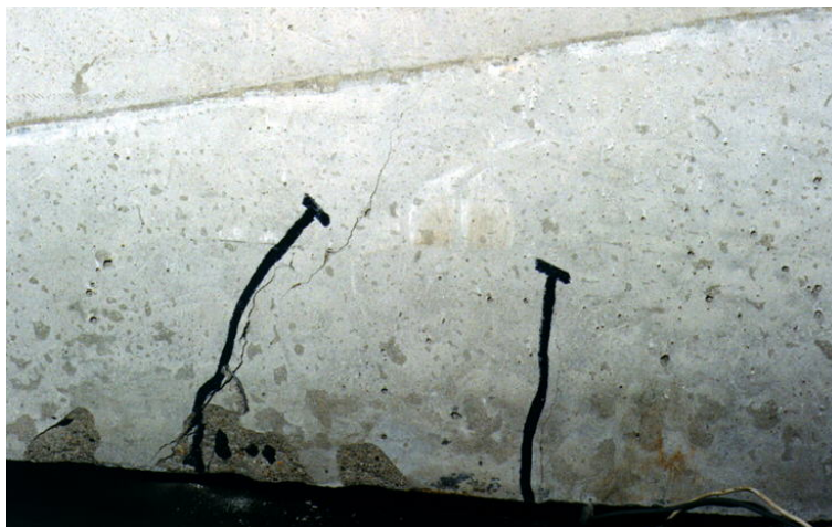
Fig. 20 - Configuração da fissuração numa das faces verticais do dormente com fibras D11, após 360.000 ciclos de carga e sob a atuação da força estática de 380 kN.
