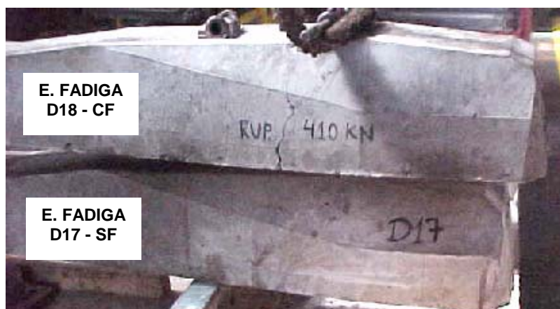
Fig. 24 - Configuração final dos dormentes D17 e D18 após o término do ensaio de fadiga.
