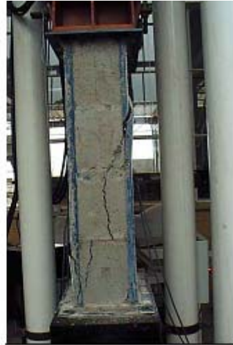
Figura 2.15 – Ruptura da parede revestida com telas soldadas
