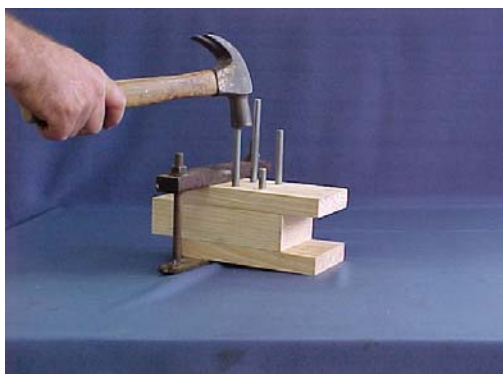
Figura 12 – Cravação dos pinos no corpo-de-prova de ligação
