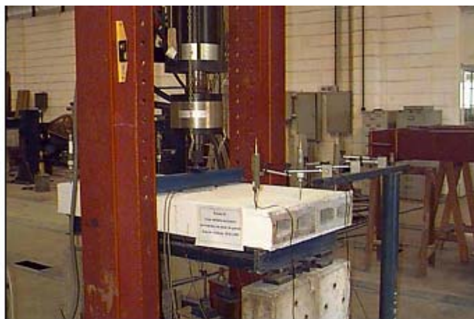
Figura 4.2 - Ensaio com carga aplicada no vão.
