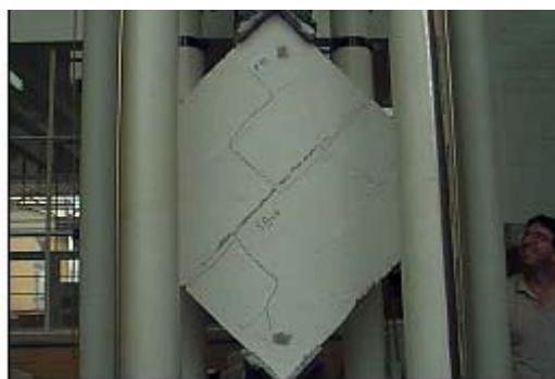
Figura 3.4 - Ruptura da parede sem revestimento.
